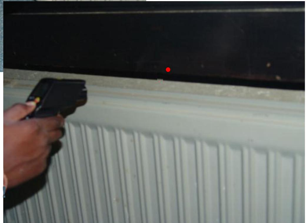
**... et température élevée du mur au dos du radiateur (35°C)**
