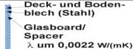
h) high-tech: Vakuumisolierung (2,5 cm)
