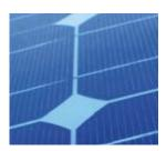
Dans une cellule photovoltaïque, la lumière du jour est directement transformée en électricité. Une cellule photovoltaïque est constituée d'une fine tranche de matériau semi-conducteur, le plus souvent du silicium. Selon le type de silicium utilisé, la part de lumière transformée en électricité est plus ou moins importante.
