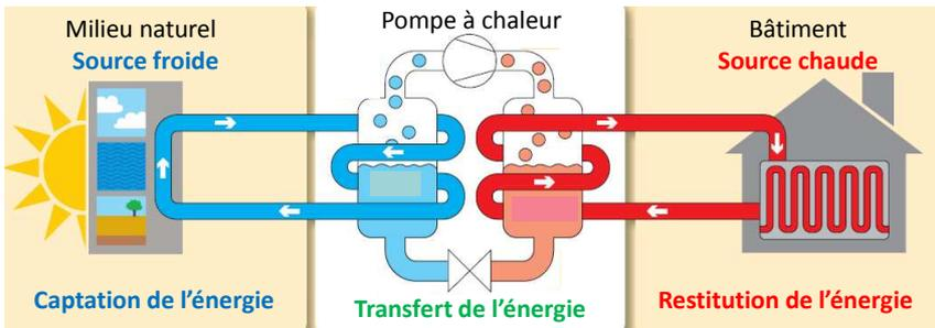
**Captation de l'énergie**      **Transfert de l'énergie**      **Restitution de l'énergie**
